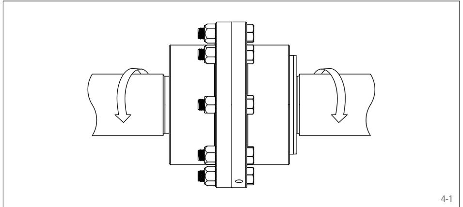
2. Ausgleich von Fluchtungsfehlern oder Wellenverlagerungen im Betrieb.
