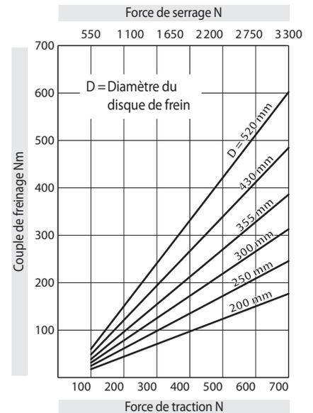
Les couples donnés dans ce tableau sont calculés avec un coefficient de friction théorique de 0,4.
