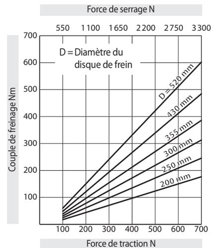
Les couples donnés dans ce tableau sont calculés avec un coefficient de friction théorique de 0,4.
