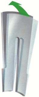
Gleichzeitig führt die Betätigungskraft zu einer Kippbewegung der Spannscheibe. Diese Bewegung wird genutzt, um eine Planfläche des Werkstücks beim Spannen gegen einen Längsanschlag zu pressen.
