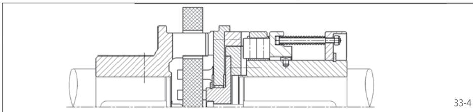
Zur drehstarran Verbindung zweier Wellen. Ausgleich großer Radial- und Winkelverlagerungen möglich.
