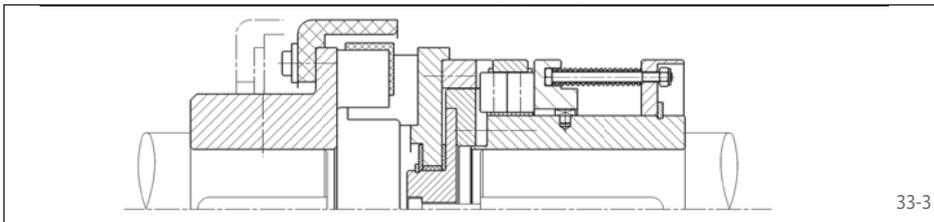
Zur elastischen Verbindung zweier Wellen. Die elastischen Elemente sind ölbeständig.
