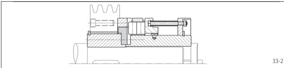
Mit langer Nabe für breite Anbauteile. Gleitlager gehört zum Lieferumfang.
