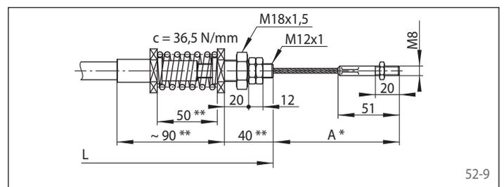
\* Bremshebel offen • \*\* Federkompensator auf 380 N eingestellt
