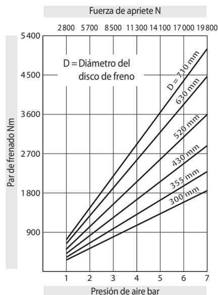
Los pares de frenado que se muestran en el diagrama se basan en un coeficiente de fricción teórico de 0,4.
